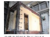
非構造部材を取り付けた鉄骨建造物の実大破壊実験
