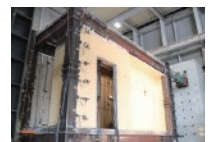
非構造部材を取り付けた鉄骨建造物の実大破壊実験
