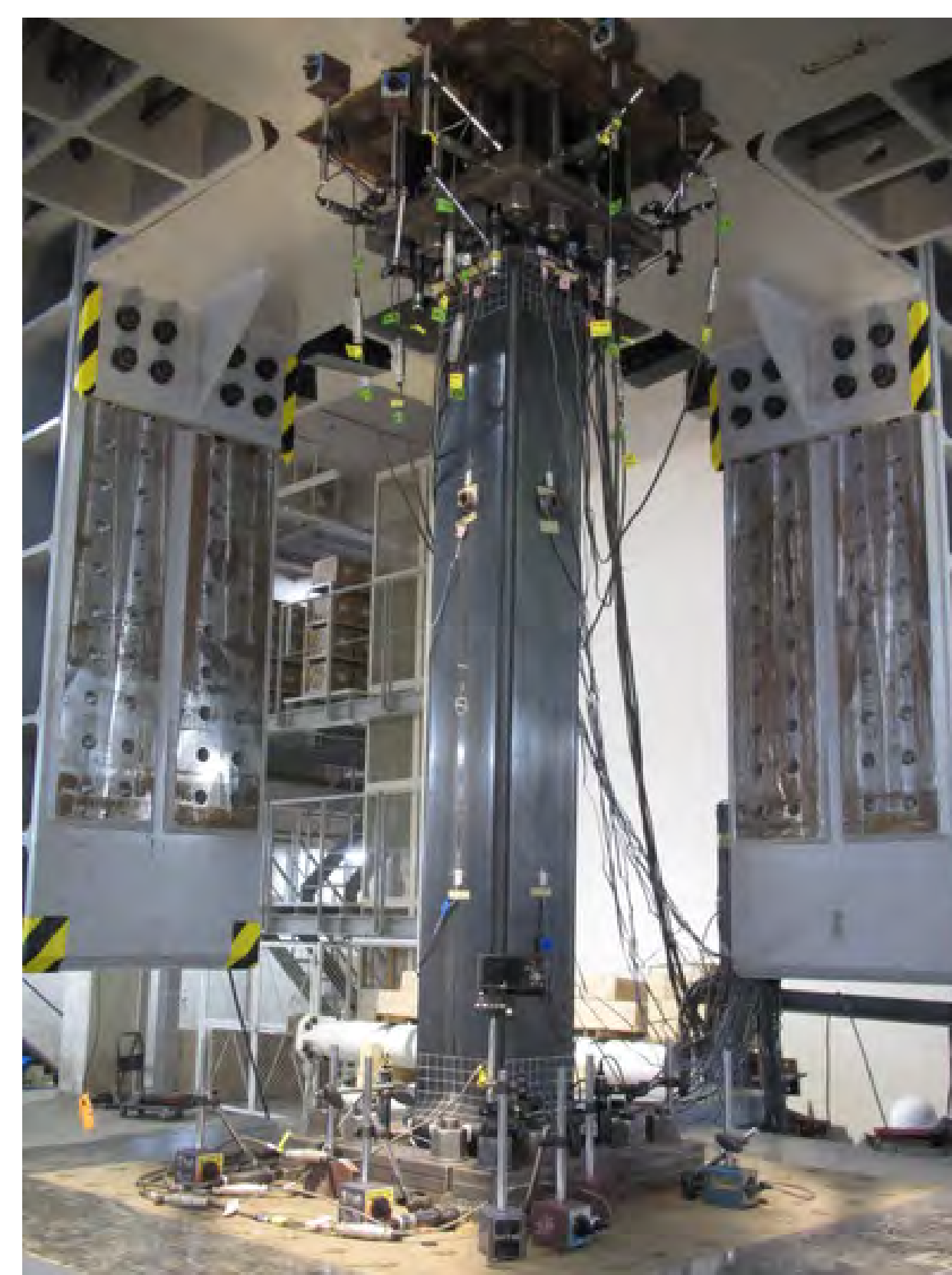
鋼管柱の2方向载荷実験
