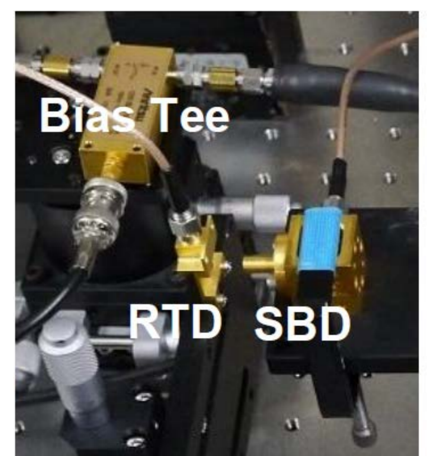
テラヘルツ無線伝送システム
