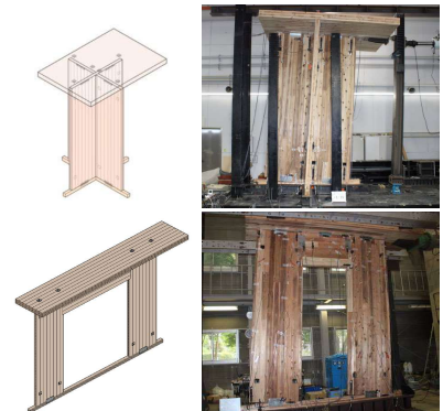
CLTパネル工法による耐力壁の 実大水平加力実験
