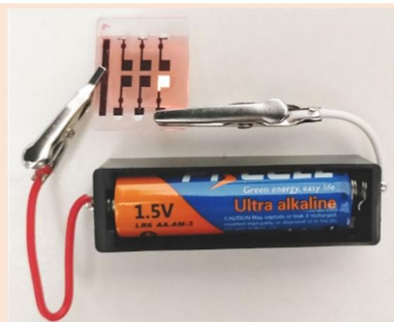
**世界最小電圧の乾電池 1本で光る有機EL**
