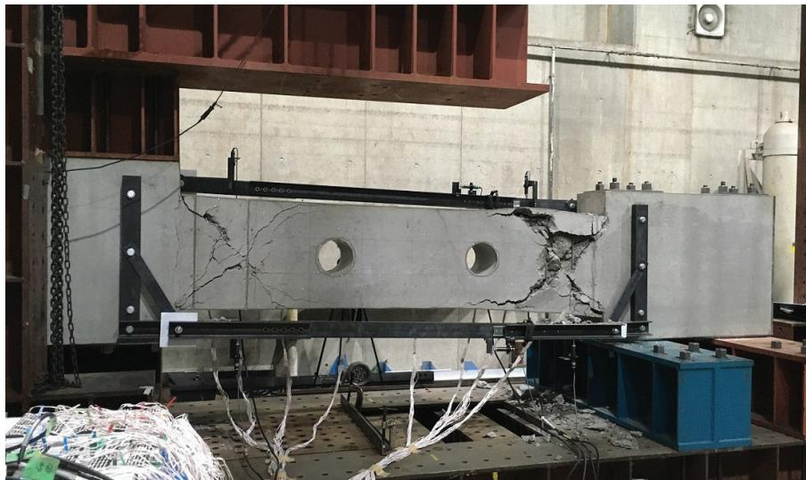
貫通孔を有するRC梁の加力実験
