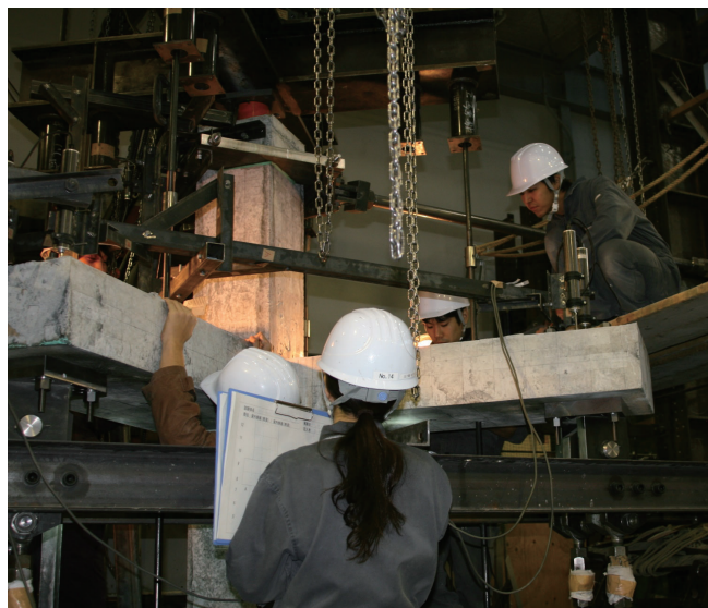
RC造の隅柱 – 梁立体接合部材の加力実験
