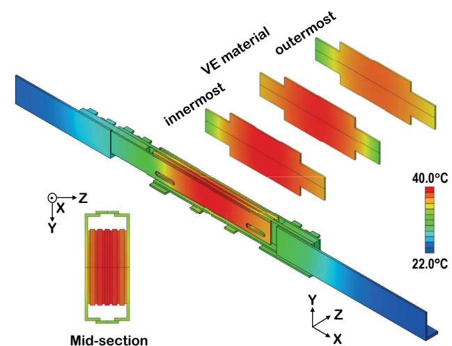
長時間加振による実大多層粘弹性ダンパーの実験・解析
