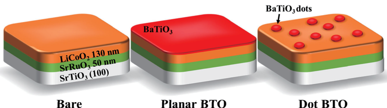
LiイオンバッテリーにおけるLiCoO 2 正極のモデル構造
